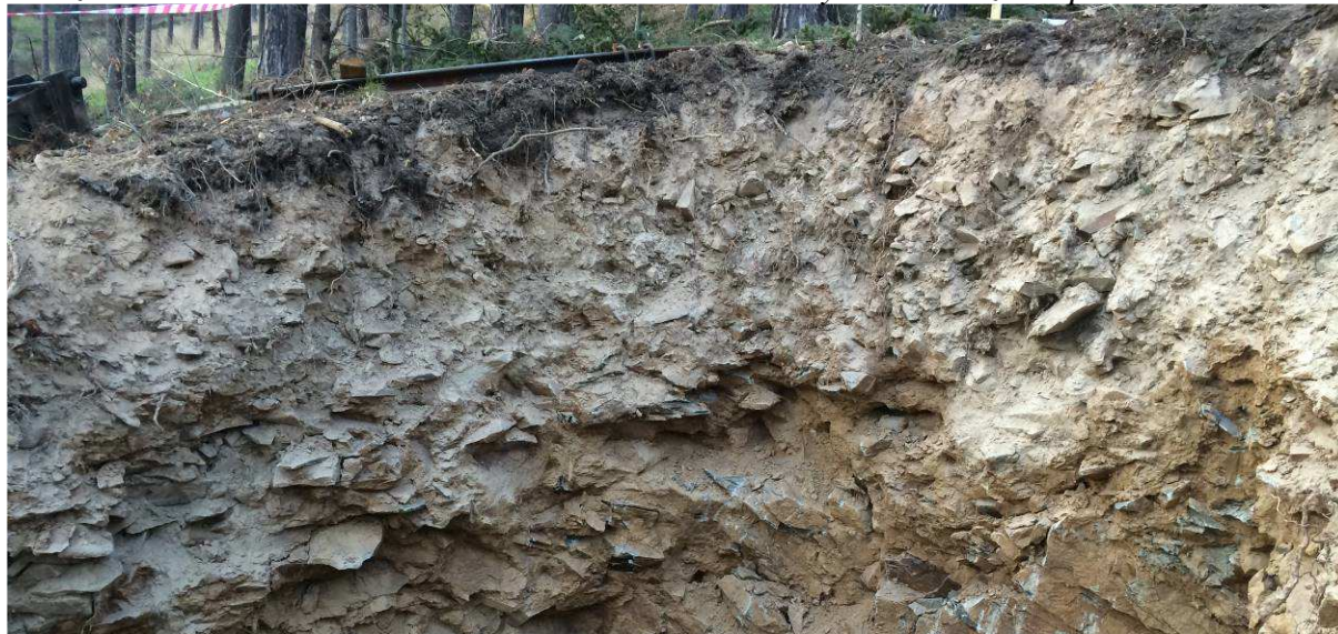
Obrázek č. 7.1: Hlinitokamenitá suť malé mocnosti v odkryvu levobřežní kopané šachtice
